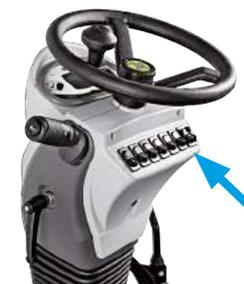
La regolazione dell'altezza del piatto semplice e precisa, è idraulica e si effettua tramite un pulsante sul cruscotto del volante, questo permette di regolare agevolmente e in continuo senza scendere dal posto di guida.
