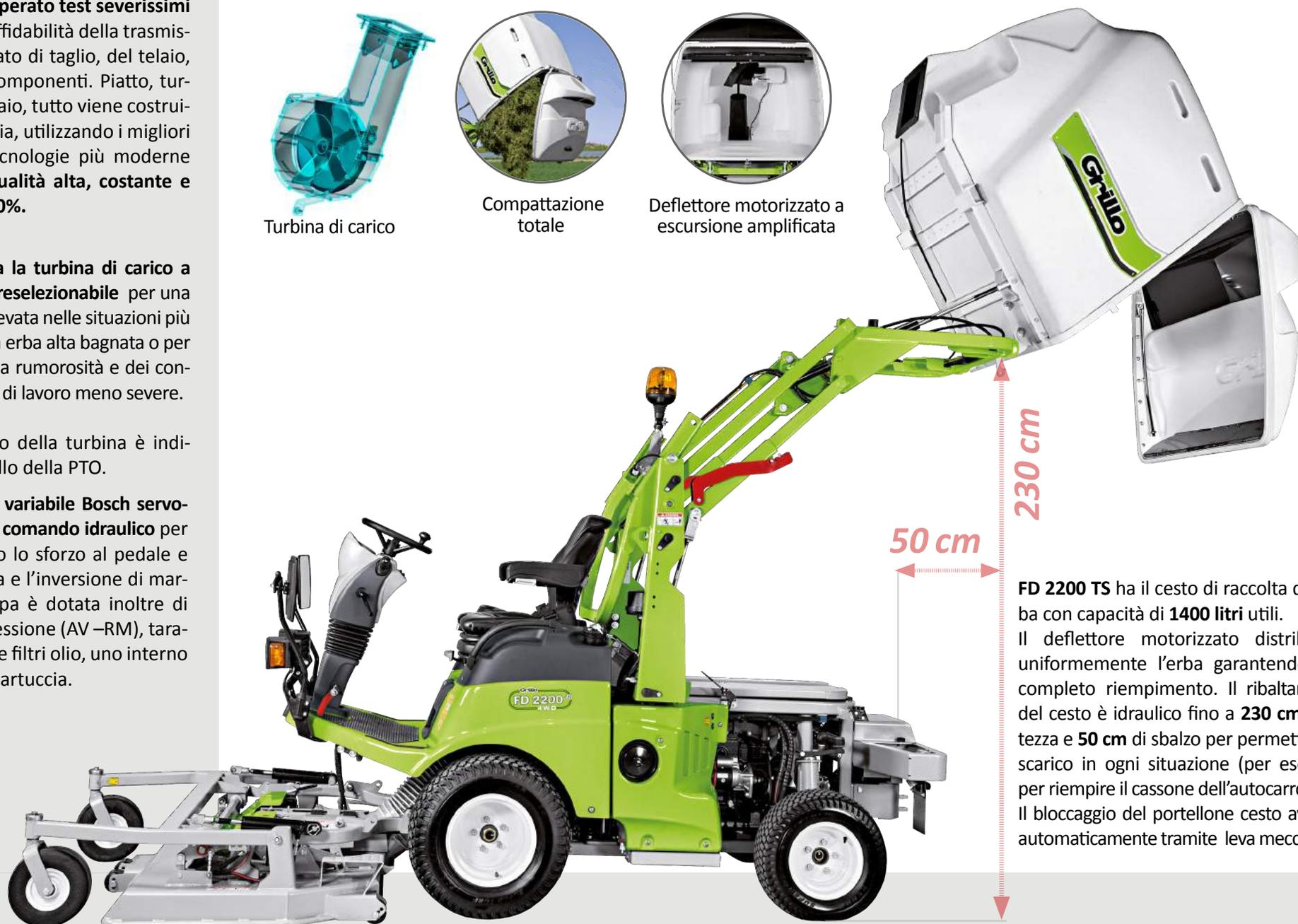
**FD 2200 TS** ha il cesto di raccolta dell'erba con capacità di **1400 litri** utili. Il deflettore motorizzato distribuisce uniformemente l'erba garantendone il completo riempimento. Il ribaltamento del cesto è idraulico fino a **230 cm** di altezza e **50 cm** di sbalzo per permettere lo scarico in ogni situazione (per esempio per riempire il cassone dell'autocarro). Il bloccaggio del portellone cesto avviene automaticamente tramite leva meccanica.
