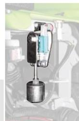
**Sistema Automatico di Stabilità** che gestisce il bloccaggio e lo sbloccaggio del differenziale quando necessario (oltre che manualmente).
