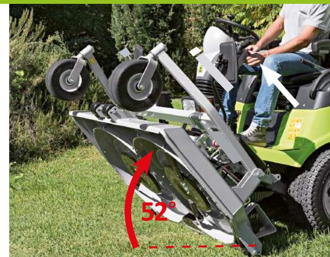
Movimento del piatto da 155 cm è attuato idraulicamente tramite pulsante posto sulla colonnetta.
