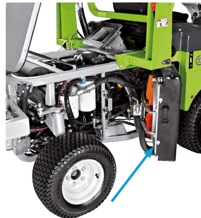
**Il gruppo radiatori si apre verso l'esterno** per facilitarne l'ispezione e la pulizia ed è dotato di un **sistema automatico di inversione del flusso della ventola** che mantiene pulita tutta la superficie della griglia e garantisce un controllo costante della temperatura.
