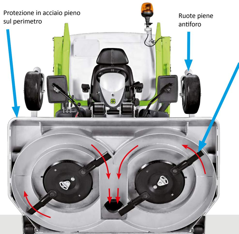
Le lame sono montate su dischi ed hanno il terminale rientrante antiurto in modo che la trasmissione sia sempre protetta dai sovraccarichi dovuti agli impatti contro ostacoli nascosti.
