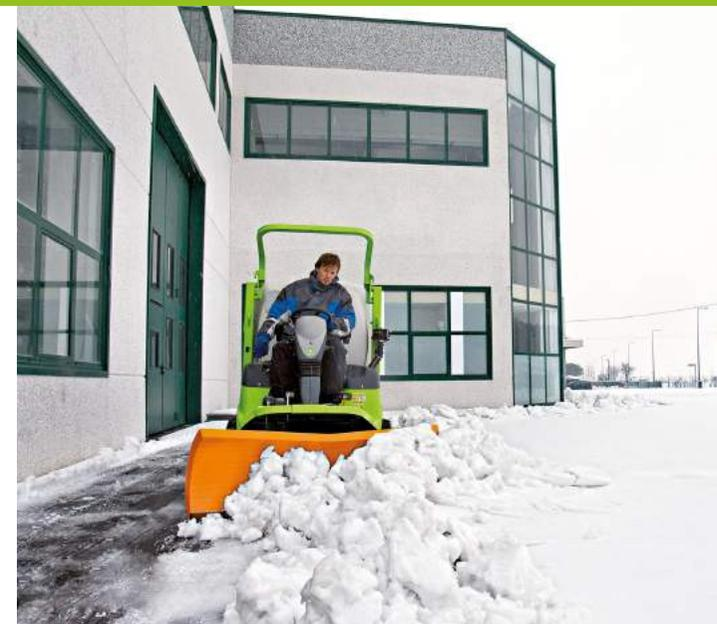
E per la stagione invernale **FD 2200** e **FD 2200 TS** hanno disponibile la **lama neve orientabile** (+/- 30°) da 175 cm con terminale in gomma, a comando idraulico performante e maneggevole.
