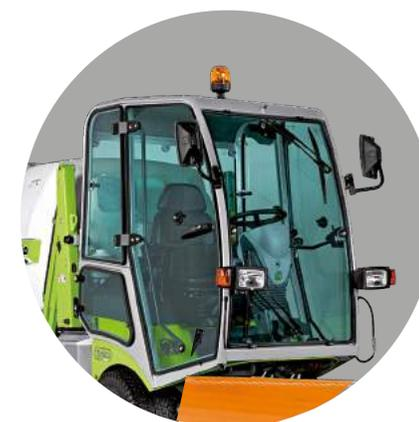
Due le versioni di cabina a disposizione: una con riscaldamento e una con riscaldamento e aria condizionata.
