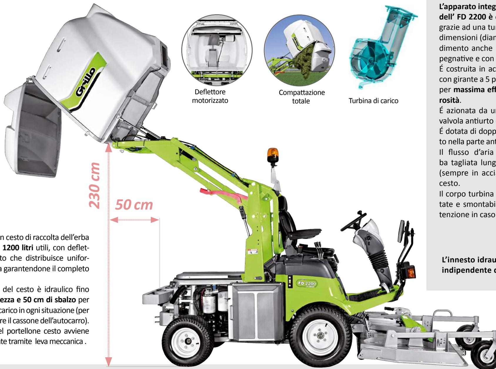
L' **FD 2200** ha un cesto di raccolta dell'erba con capacità di **1200 litri** utili, con deflettore motorizzato che distribuisce uniformemente l'erba garantendone il completo riempimento.
