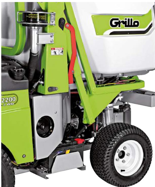
É facile accedere al prefiltro, al filtro aria motore, al filtro e al decantatore gasolio e ai filtri olio idraulico. Anche la batteria è comodamente raggiungibile così come il tendicinghia e la frizione elettro idraulica della PTO.
